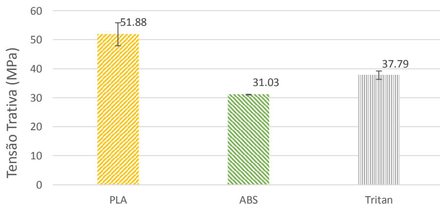
Figura 28 - Gráfico comparativo da resistência à tração média dos materiais testados.
