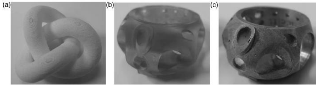
Figura 17 - Design artístico auxiliado por MA: (a) Modelo artístico, (b) modelo de jóia fabricado por MA, (c) Anel de prata produzido por fundição à vácuo [67].
